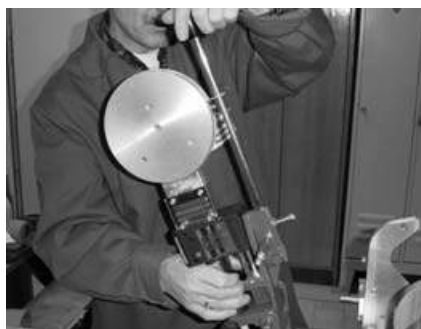
Fig. 1 Colocar el espejo de soldadura en el herramienta de sujeción
