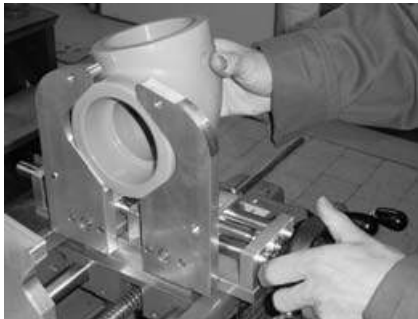
Fig. 6 Colocar el accesorio en la mordaza y enclavar
