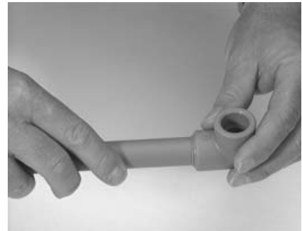
Fig. 6 Reajustar el tubo y la matriz en el tiempo máximo permitido y unirlos, sin girar los elementos.
