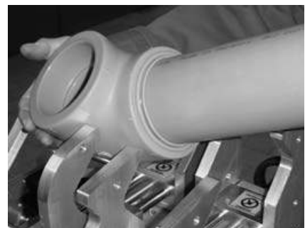
Fig. 12 Transcurrido el tiempo de refrigeración, extraer la unión soldada de las mordazas
