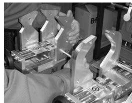
Fig. 3 Fijar las mordazas prensoras en la herramienta de sujeción
