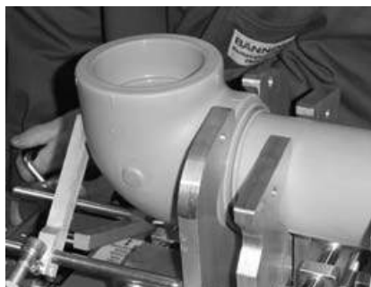
Fig. 11 Juntar los carros hasta el fin de carrera
