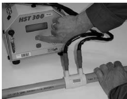
Fig. 7 Enchufar los conectores de cable en las hembrillas de contacto. Ajustar el diámetro de los tubos que van a ser fusionados e iniciar la soldadura pulsando el interruptor.
