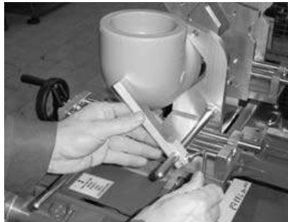
Fig. 7 Enclavar tope para sujeción del accesorio
