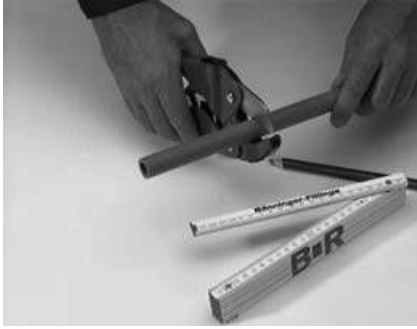
Fig. 1 Cortar el tubo en ángulo recto respecto al eje del mismo con ayuda de una tijera cortatubo o un cortatubo.
