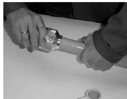
Fig. 3 Antes de soldar los tubos compuestos Stabi de Bänninger hay que pelar toda la capa de aluminio que recubre el tubo con el pelatubo (Código 8977).
